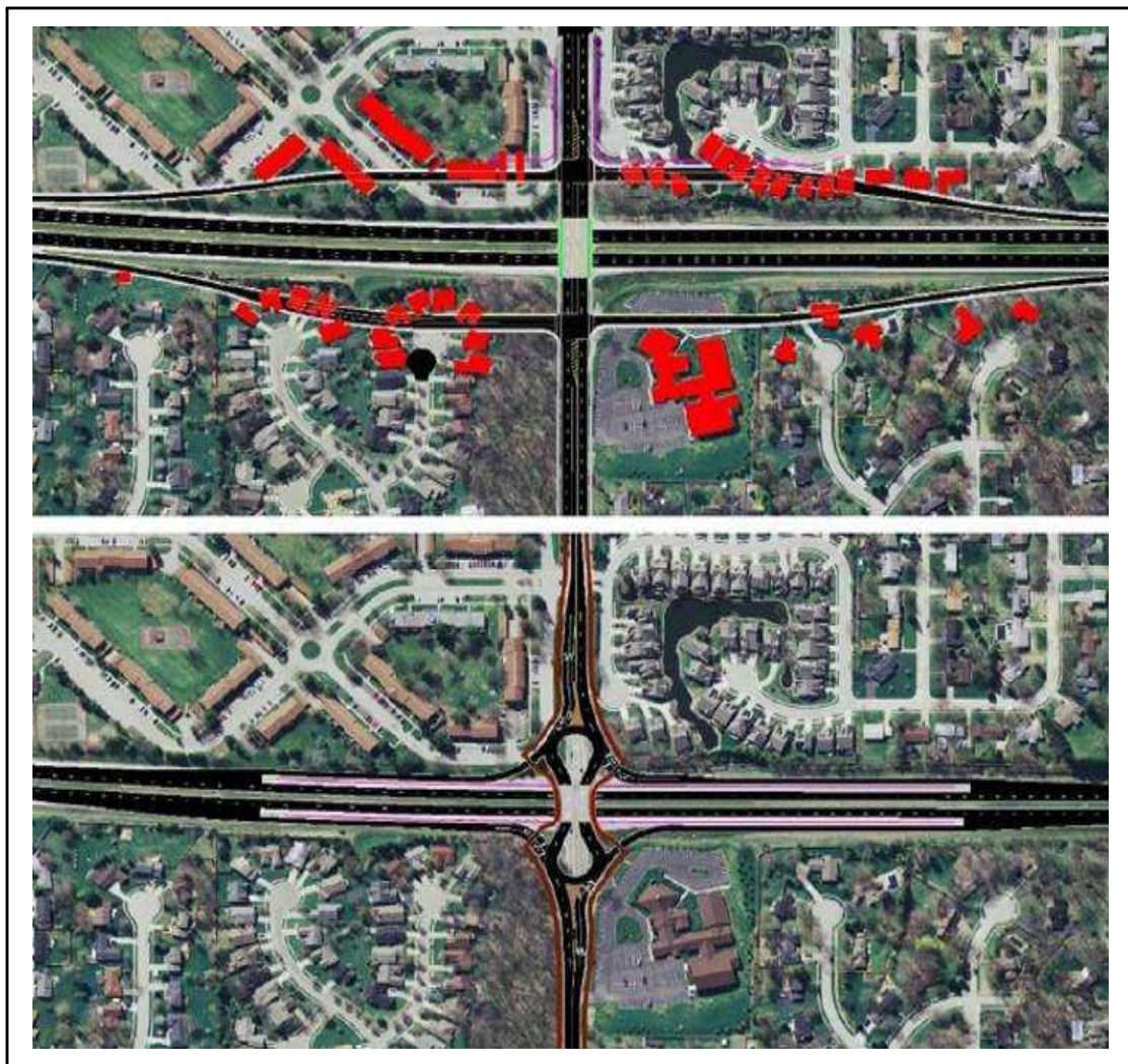
<그림 6-4-12> T-drop 회전교차로 적용시 교차로 면적 축소예시(미국Carmel)
