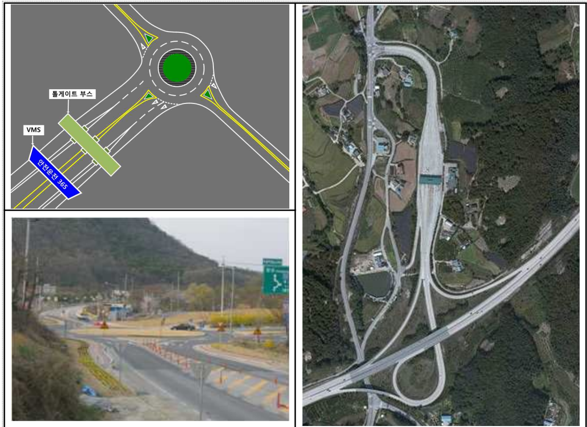
<그림 6-4-1> 고속도로 톨게이트 진·출입로 회전교차로 예(북원주 IC)
