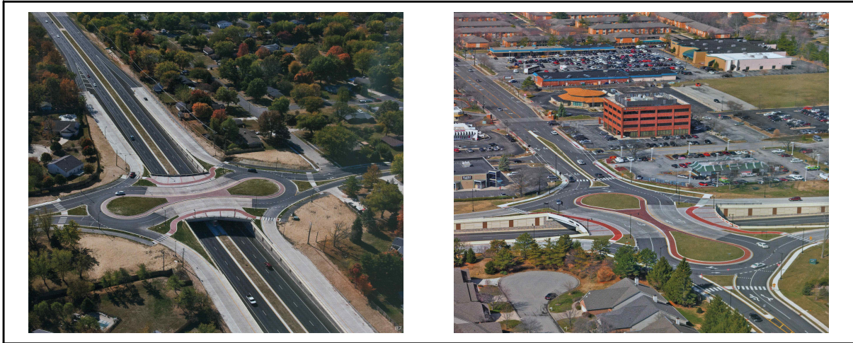
<그림 6-2-4> 평면형 회전교차로(Tears-Drop형) 예시도
